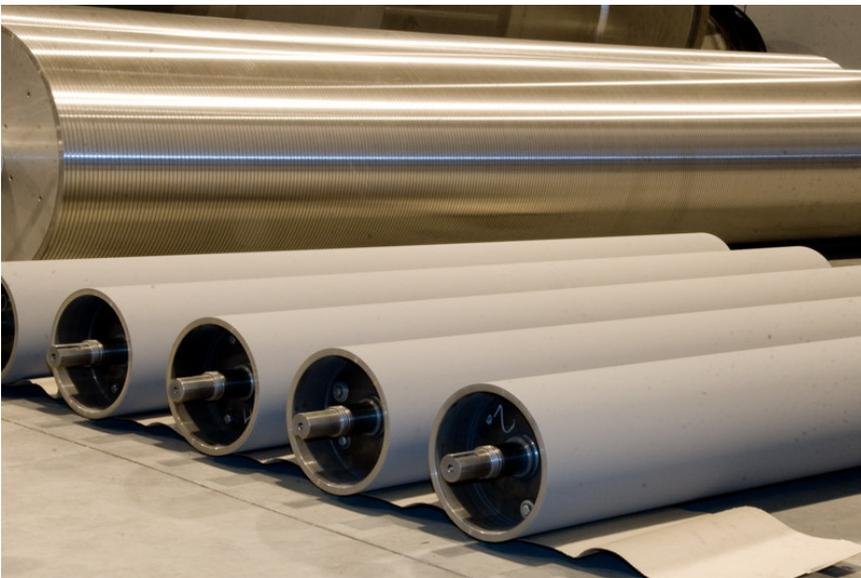
**Abb.4: Leitwalzen mit Schutzbeschichtung**
